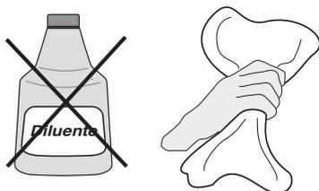
**Pulire** con un panno morbido asciutto. Non usare prodotti abrasivi o a base di solventi che compromettano la protezione anticorrosione.
