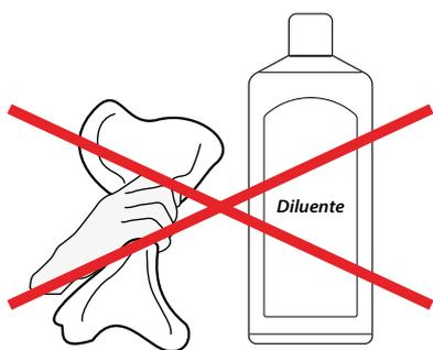
Evitare l'uso di prodotti che potrebbero compromettere la protezione anticorrosione della ferramenta.
